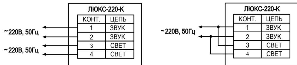
Рис.1. Схемы подключения.
